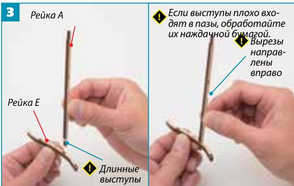
**3** Соедините рейки А и Е. Нанесите клей на длинный выступ рейки А и закрепите ее в паз рейки Е до упора, как показано на рисунке выше.
