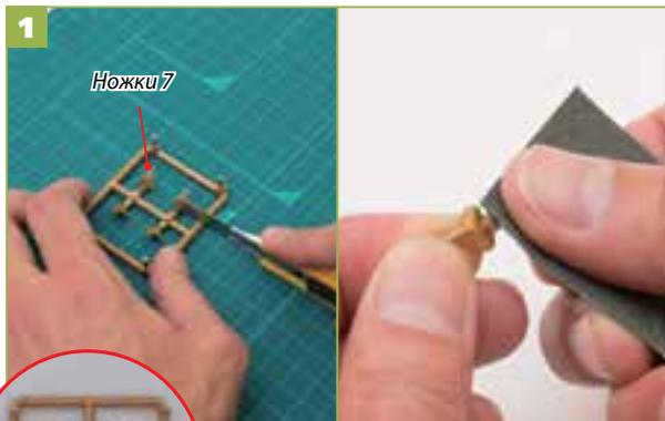
**1** Отсоедините 4 ножки плиты. Обработайте места присоединения наждачной бумагой.
